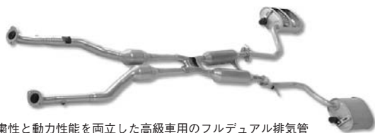
静粛性と動力性能を両立した高級車用のフルデュアル排気管
