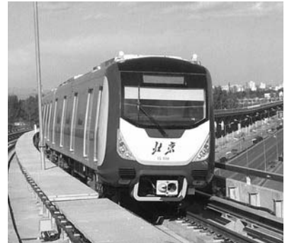
完全無線式列車制御システム「SPARCS」が採用された北京地下鉄15号線
