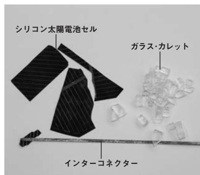
TASC処理により回収された太陽光発電パネルの有価物
