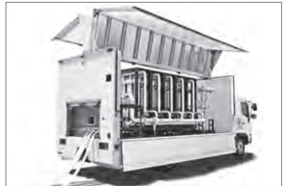
Miracle N7は、固定式の消火設備ではなく「消防車」なので、地震による損傷を受ける可能性が少なく、また、移動が可能であることから設置場所を特定されにくく、テロ対策という観点からも優位性を持つ。
