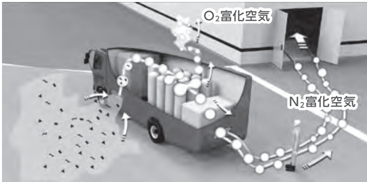
Miracle N7は、固定式の消火設備ではなく「消防車」なので、地震による損傷を受ける可能性が少なく、また、移動が可能であることから設置場所を特定されにくく、テロ対策という観点からも優位性を持つ。
