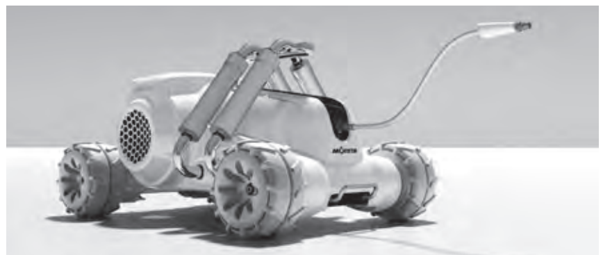
近未来型消防車のコンセプトモデル「Hobot-mini」。大型のベビーカー程度のサイズで、乗用ではなくリモコンによる操縦を想定して設計している。外部に露出したパイプのように見える部分は、窒素富化空気システムの心臓部である分離膜容器。近未来感あふれるデザインのワンポイントにもなっている。「消防車両は、発注者の仕様・要件に合わせて生産するフルオーダー製品。分離膜容器を搭載する場所や方法も自由度が高いことを表現するためのデザイン」と、モリタホールディングスの関氏は言う。2015年6月にドイツで開催された世界最大級の消防防災展「INTERSCHUTZ」に出展した際には、海外市場からも高い関心が寄せられた。翌2016年には「iFデザイン賞」 ※3 を受賞している。
