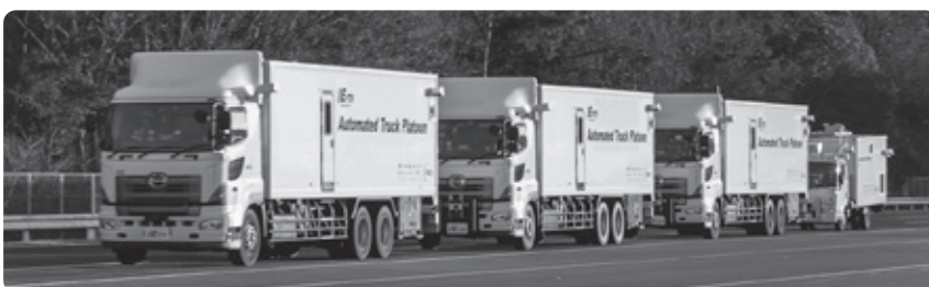
トラック4台による自動運転・隊列走行の実証実験 (NEDOエネルギー ITSプロジェクト)
