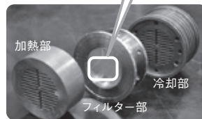
網目状のフィルターの両端に温度差をつくり、音波を生み出す
