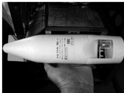
トウモロコシ由来の生分解性樹脂を使って開発した観測装置「ドロップゾンデ」
