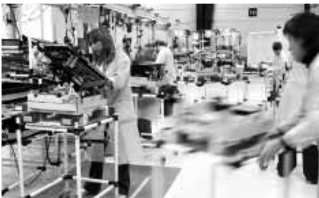
ベルトコンベアによる量産ラインでなく、作業する1人当たりの作業工程を増やし少人数で1つの製品を組み立てる「セル生産方式」
