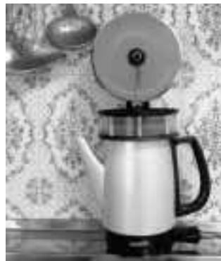
スターリングエンジン(電気ポットで実験)
