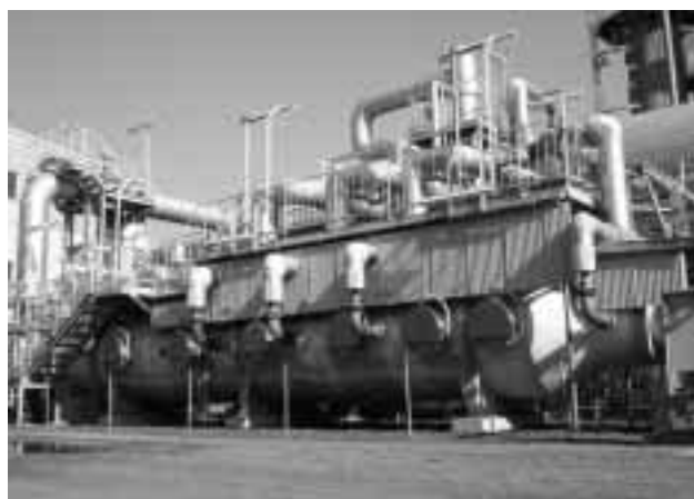
ナイロンなどの原料となるアジピン酸の製造工程では、温室効果ガスの亜酸化窒素を分解する装置により、排出量を半減させた(旭化成ケミカルズ延岡製造所、宮崎県延岡市)
