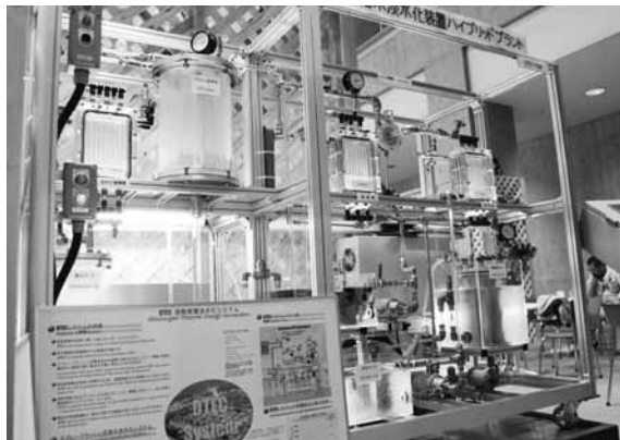
海洋温度差発電・海水淡水化装置ハイブリッドプラントの模型
