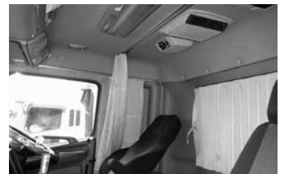
車内後部のドライバー用寝台スペース上部に冷気の吹き出し口がある。
