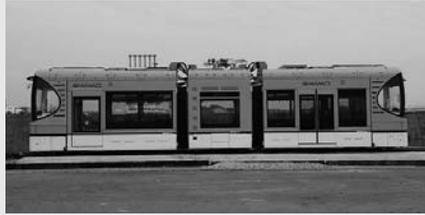
新開発の極めてコンパクトな台車を車両の両端部とほぼ中央に配置するという、世界で初めての斬新な発想による3車体3台車連節構造である。
