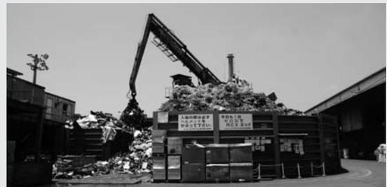
富士宮工場に持ち込まれた廃自動車を破碎機に投入する作業
