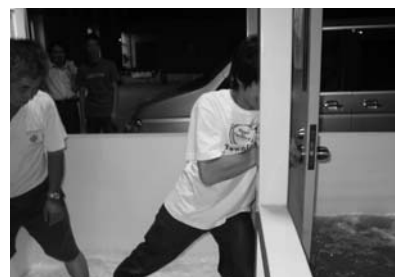
写真2:ドア押し開けの避難実験
