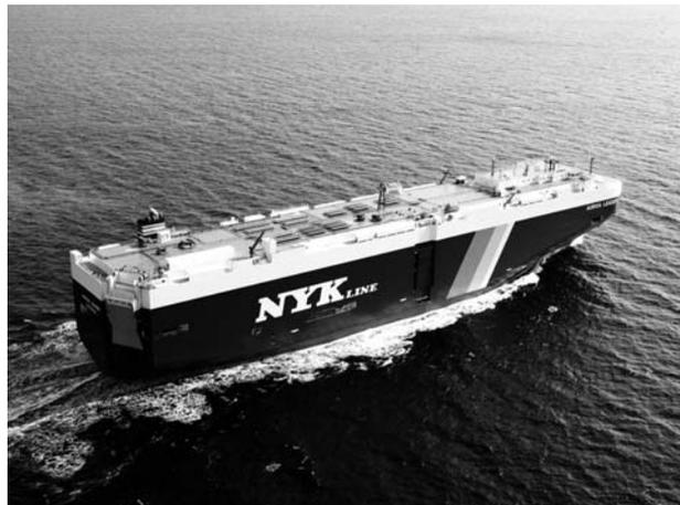
自動車運搬船「アウリガ・リーダー」(全長:199.99メートル、総トン数:6万213トン)。デッキ上に328枚の太陽光パネルを搭載し、最大で動力用電力の0.3%、照明などの生活電力の6.9%を賅う。
