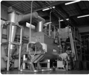
5トン以上の高速堆肥化施設として東京都認可第1号となった「IGARASHI資源リサイクルセンター」の堆肥化設備
