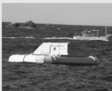
和歌山県で海上試験を行った50kW級試験機
