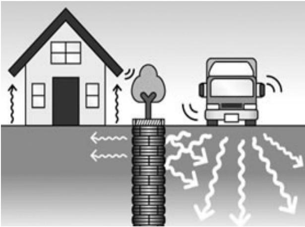
タイタン工法による防振対策のイメージ図
