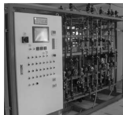
TT処理技術を採用した海水淡水化前処理の実験装置
