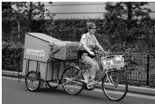
リヤカーを電動アシスト自転車で牽引する「新スリーター」
