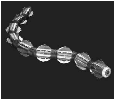
図3:水陸両用ヘビ型ロボットACM-R5
