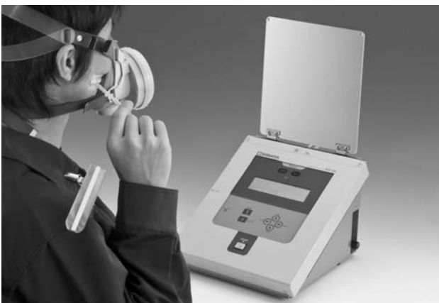
マスクの外側と内側の漏れ率を測定する「マスクフィッティングテスター MT-03型」
